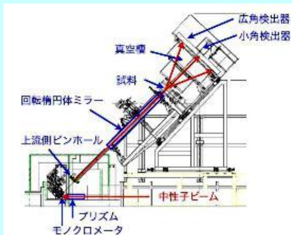
(a) mf-SANS 第 1 号機 小型集束型中性子小角散乱装置 (JRR3)
